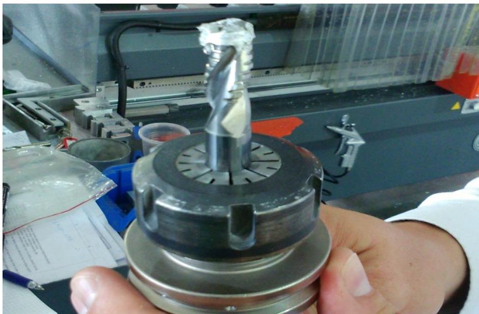
Slika 16. Lijepljenje odvojene čestice za alat
