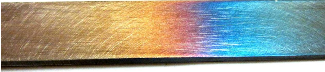
Slika 6. Kaljeni čelik nakon popuštanja ( različite boje pokazuju temperature na koje je čelik bio zagrijan )
