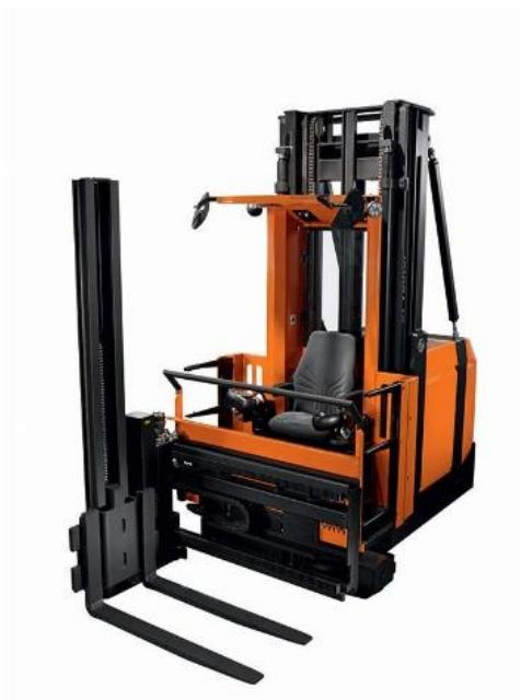
Slika 4. Električni visokoregalni viličar BT Vector A
