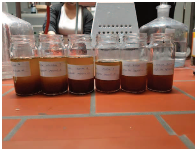
Slika 21. Ulje spremno za taloženje (Vlastiti izvor)
