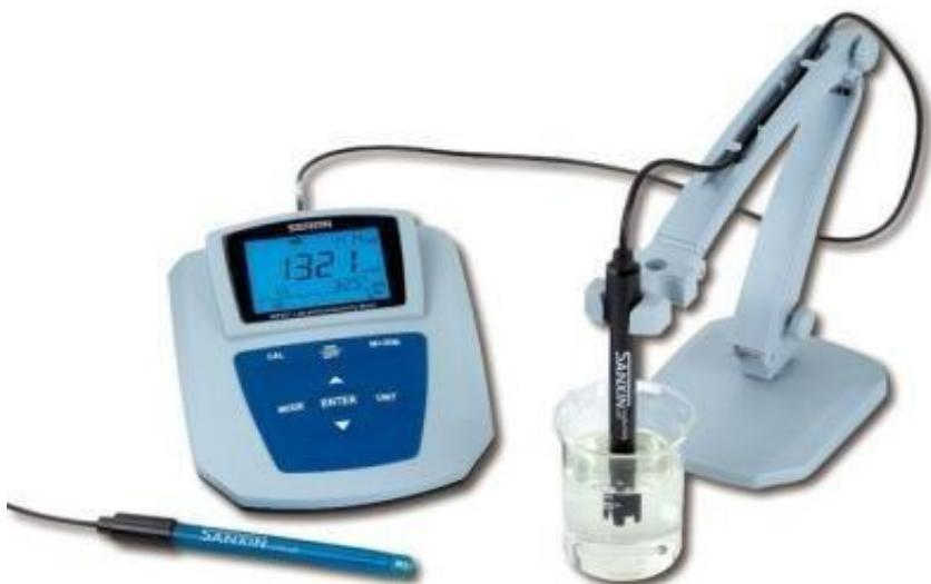
Slika 6.Stolni konduktometar(Kemolab.hr, 16.6.2016.,url)
