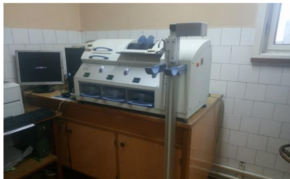
Slika 5. Uređaj ekstenzograma u laboratoriju Papuka (Izvor: autor )
