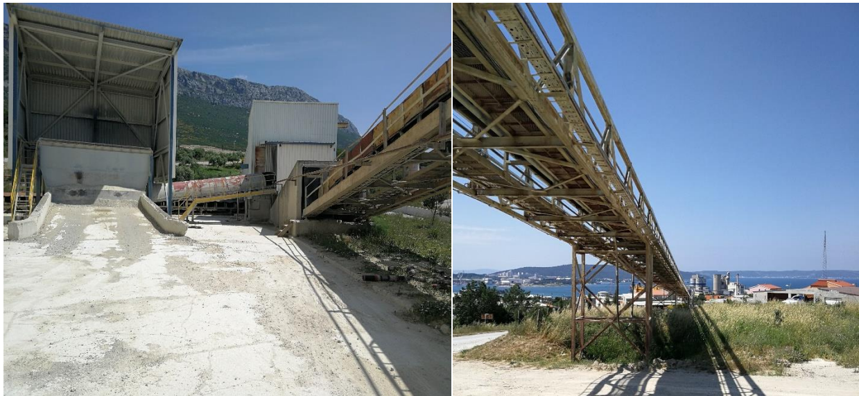
Slika 28. Rampa sa bočnom trakom namijenjena za dodavanje usitnjenog kamena i traka kojom sirovina nastavlja put tvornice
