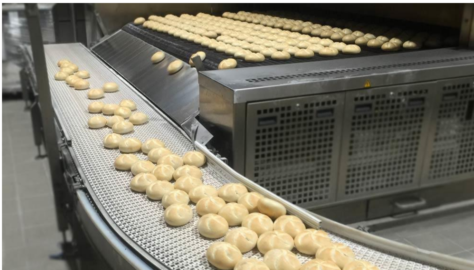
Slika 17. Primjena trakastog transportera u proizvodnji kruha
