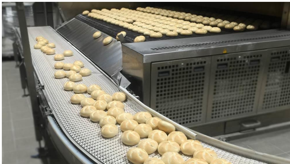
Slika 17. Primjena trakastog transportera u proizvodnji kruha
