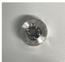
Slika 2.1: Membrana 2 \times 2 \text{ mm}^2 debljine 50 \text{ nm} zalijepljena na držač.
